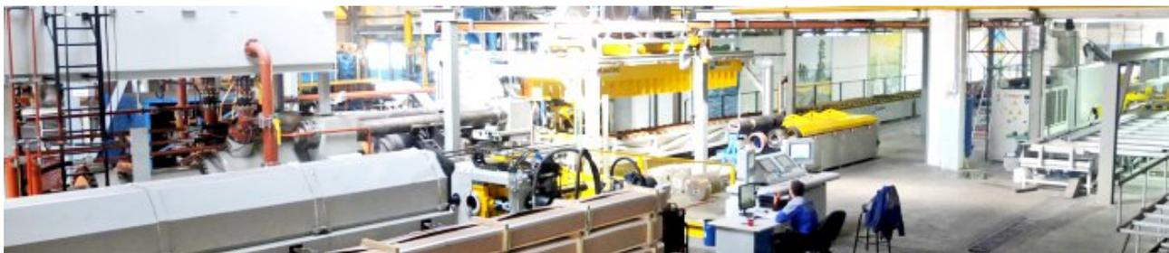
Алюминиевым профилем называют современный легкий и прочный конструкционный материал, который позволяет создавать инженерные системы различного назначения. Алюминиевый профиль получают методом горячей экструзии. Исходным сырьем являются сплавы на основе алюминия.
